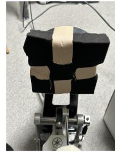
図5 電子ドラムに取り付けたウレタンフォームのスポンジ
