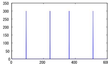
フーリエ変換の結果、スペクトルが得られる。このグラフは、その絶対値をとったものであり、振幅スペクトルとよぶ。FFT を用いて推定した振幅スペクトルは、グラフの真んを中心とした線対称になる。
